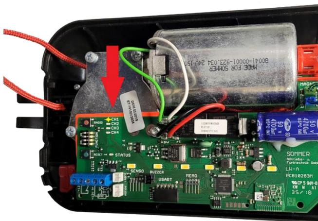
4. Para programar el segundo botón (función de iluminación para modelos con LED en el carro motor), simplemente presione dos veces el botón de programación "radio", el diodo CH2 se iluminará.
