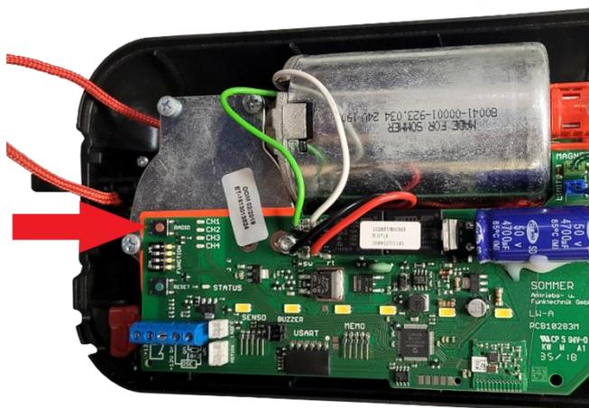
2. Presione el botón de radio una vez; se encenderá un diodo. Puede estar ubicado en diferentes lugares según el modelo del motor.
