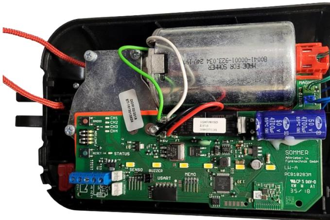
Identifique el botón de programación en la placa electrónica. Está etiquetado como "Radio" .
